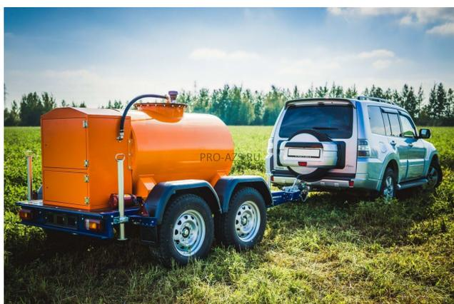
Мобильный топливный модуль, мини АЗС, объемом 950 литров для заправки спецтехники (трактор, бульдозер, комбайн, кран) и прочих автомобилей
